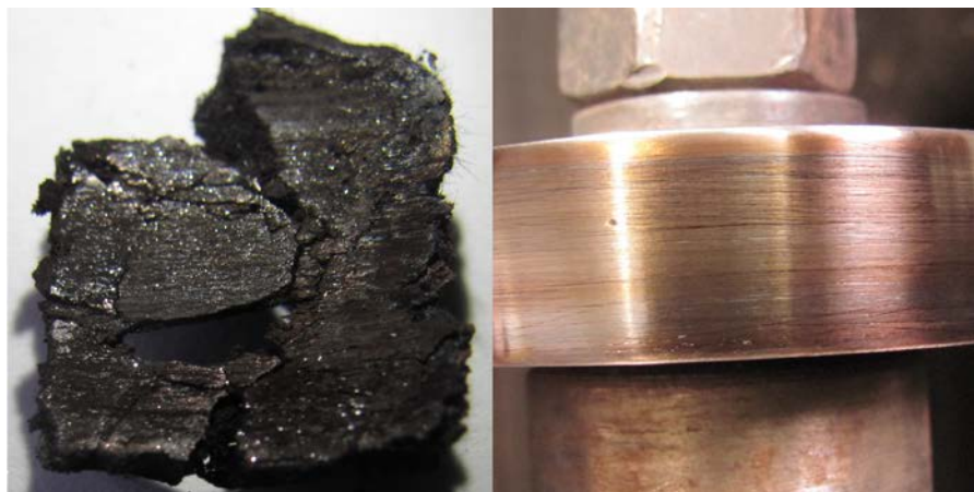
Рис. 4.25. Загальний вигляд трибоповерхні зразка і контртіла: а – зразок складу № 1; б – зразок складу № 2
