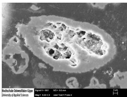
Рис. 4.13. Мікроструктура поверхні епоксикомпозитного матеріалу складу № 6
