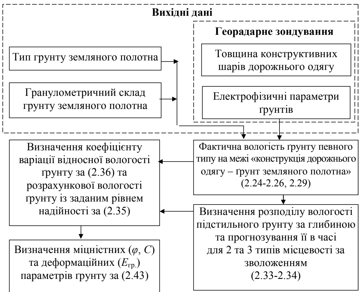
Рисунок 2.9 – Схема алгоритму оцінювання розрахункових параметрів ґрунтів у розрахунковий період та під час максимального вологонакопичення
