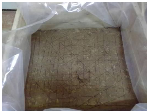
Рисунок 3.6 – Формування нижнього шару ґрунтової моделі
