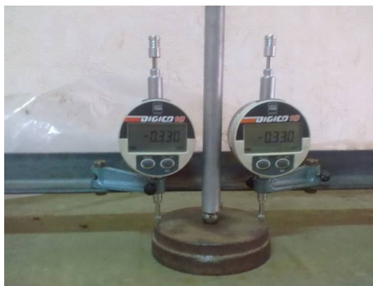
Рисунок 3.10 – Вимірювання вертикального переміщення штампу датчиками електронного типу DIGICO 10
