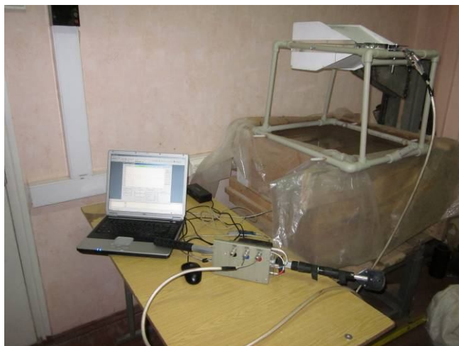
Рисунок 3.3 – Георадарний комплекс «ОДЯГ-1» під час проведення лабораторних досліджень
