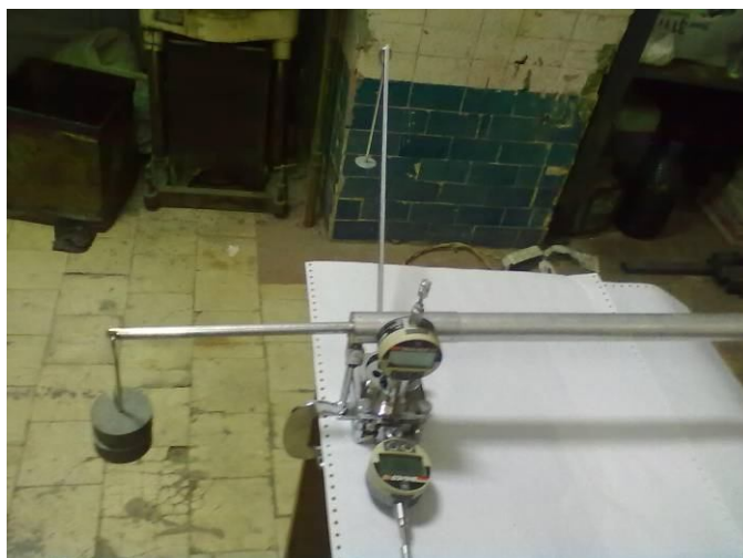
Рисунок 3.1 – Прилад конструкції І.М. Литвинова для визначення міцнісних параметрів за принципом одноплощинного зрізу
