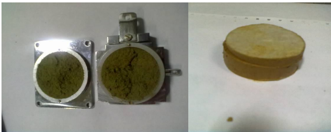
Рисунок 3.17 – Зразки ґрунту супіску (ліворуч) та суглинку (праворуч) на яких відбувся зсув від прикладеного граничного навантаження зсуву
