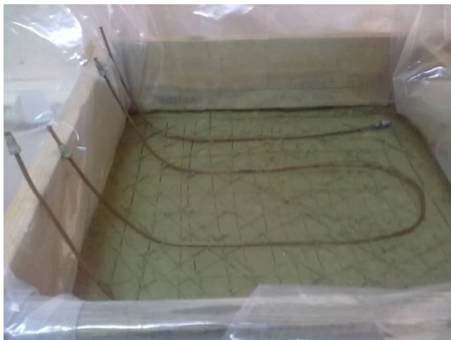
Рисунок 3.8 – Закладання мідних трубок в ґрунтову модель
