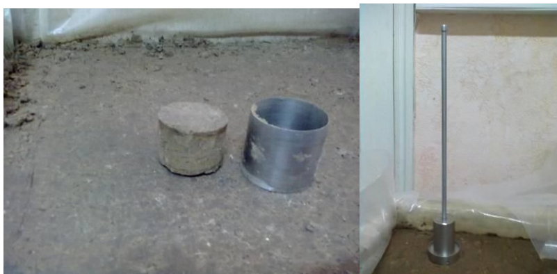
Рисунок 3.7 – Перевірка щільності ґрунту під час трамбування
