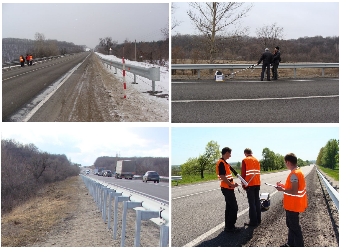
Рисунок 3.38 – Проведення георадарного обстеження ділянки об'їзної автомобільної дороги м. Харків в різні періоди року
