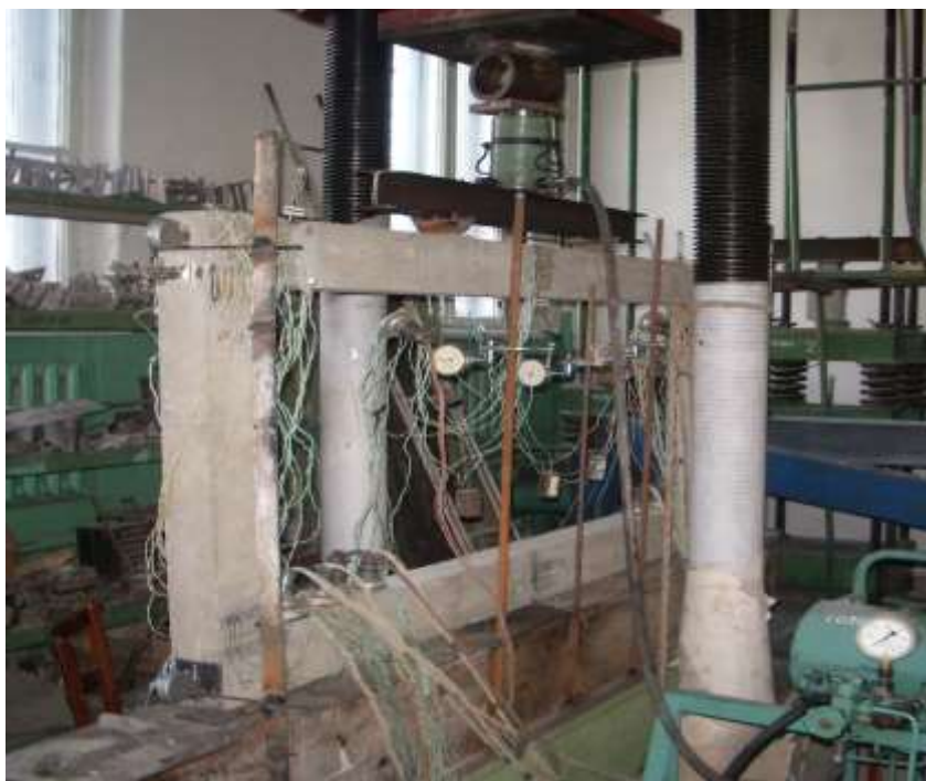
Рис. 5.3. Загальний вигляд випробовування рам.
