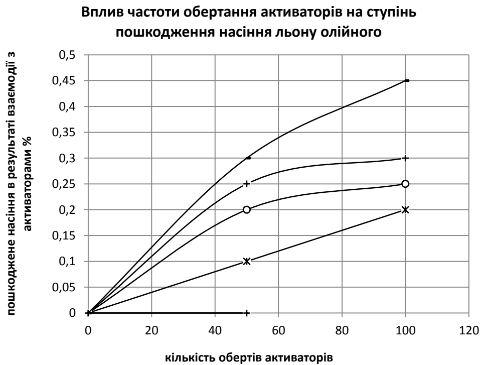
Рисунок 4.7 – Вплив частоти обертання спіралеподібних активаторів при k_s/D_s = 1,25 на ступінь механічного пошкодження насіння льону олійного при його забрудненні 45-50 %: а – відносна вологість матеріалу 9 %; б – відносна вологість матеріалу 17 %
