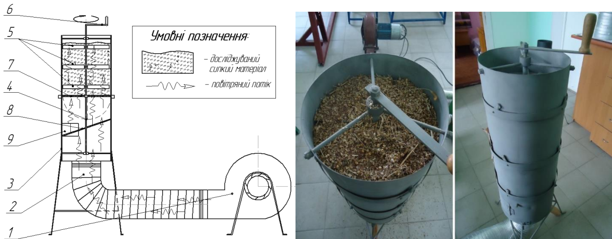
Рисунок 3.3 – Установка для проведення дослідження вентилявання матеріалу повітряним потоком: 1 – вентилятор; 2 – гнучкий повітропровід; 3 – циліндрична камера; 4 – вал; 5 – лопаті; 6 – рукоятка; 7 – перфороване дно з механізмом вивантаження; 8 – перфорована похила поверхня; 9 – вивантажувальне вікно
