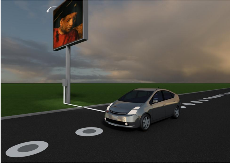
Рис. 3. Загальний вигляд установки. П'єзопластини, провідник, конденсатор, світло-діоди.
