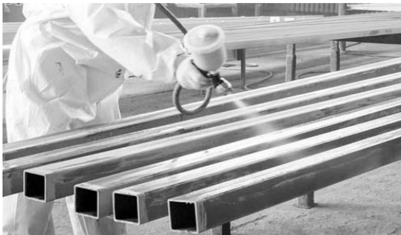
Рис 3. Метод холодного цинкування
