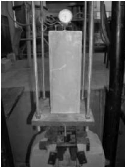
Рис. 2. Загальний вигляд випробування бетонних призм
