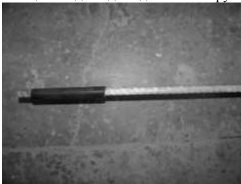
Рис. 3. Захист арматурного стержня від пошкодження в захваті преса
