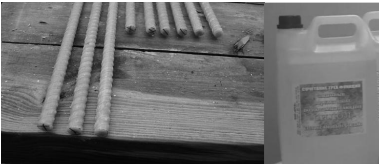
Рис. 1. Композитна склопластикова арматура діаметром 16 мм: о – не покрита композицією «СІЛОЛ®»; - – покрита в 1 шар композицією «СІЛОЛ®» х – покрита в 2 шари композицією «СІЛОЛ®»
