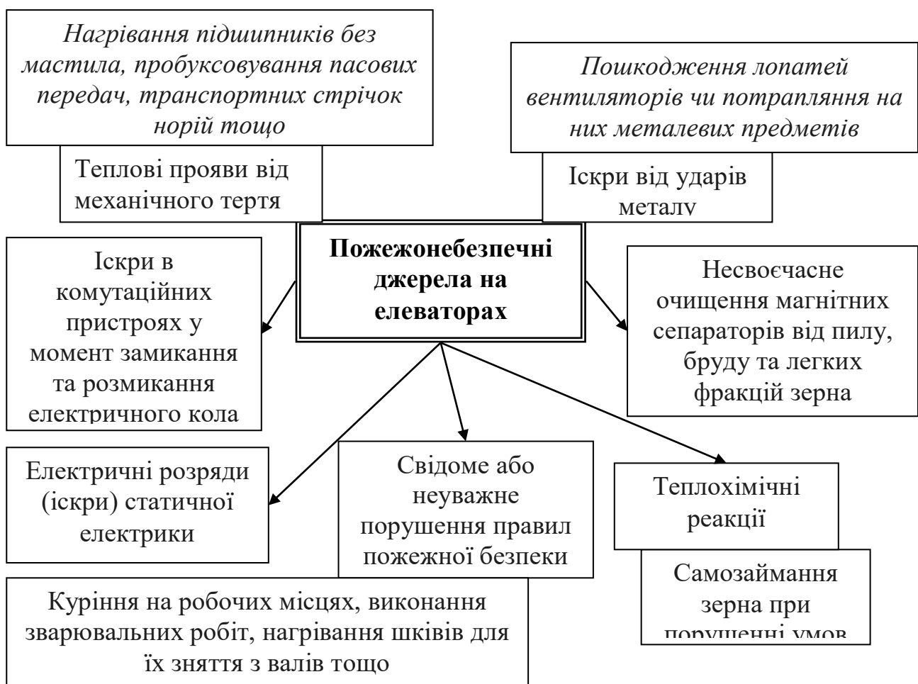
Рис. 2. Потенційні пожежонебезпечні джерела у виробничих приміщеннях елеватора
