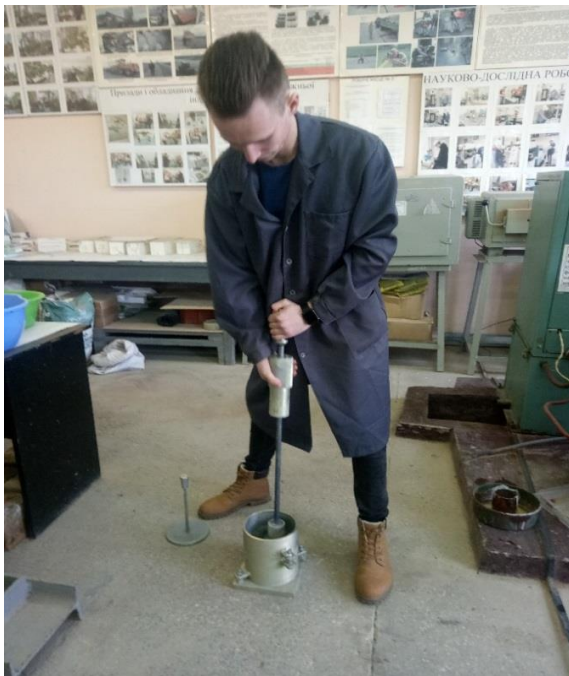
Рис. 3. Визначення щільності методом Проктора
