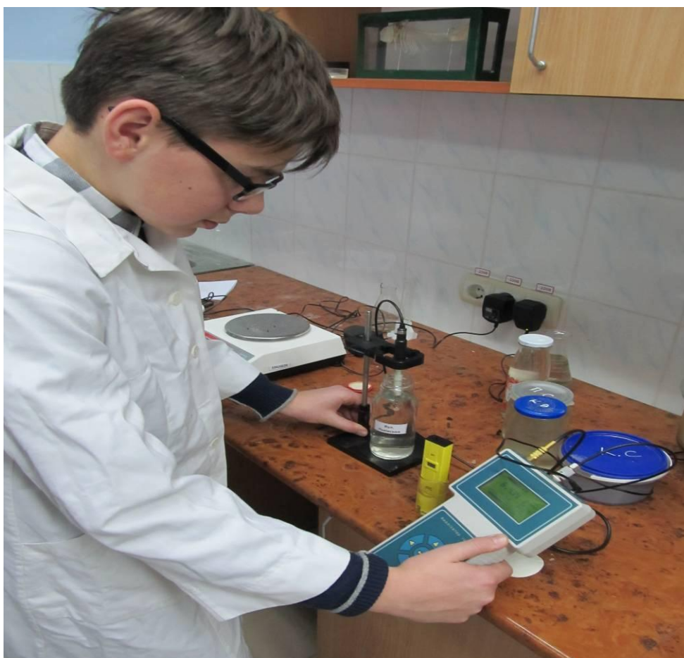
Рис. 2. Вимірювання кислотності зразків опадів в лабораторії кафедри екології Луцького НТУ.
