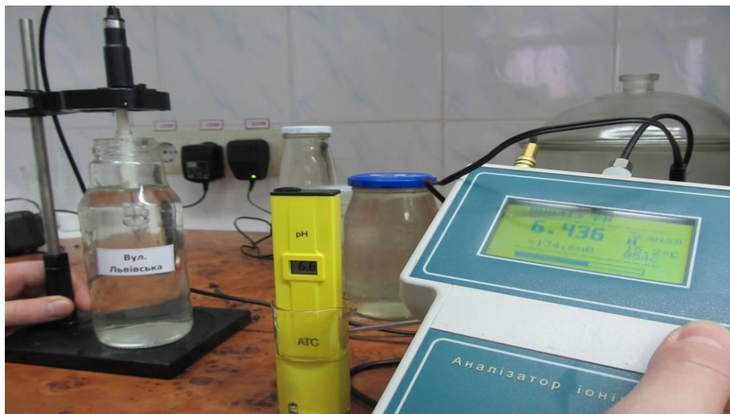
Рис. 1. Вимірювання кислотності зразка опадів за допомогою рН-метрів АТС (на фото – зліва) та АІ-123 (на фото – справа).
