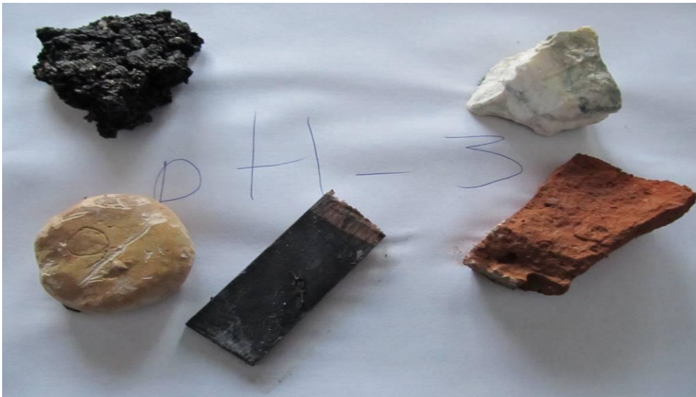
Рис.4.2. Фото зразків, що досліджувалися, після експерименту занурення на 45 діб : а) рН=3.
