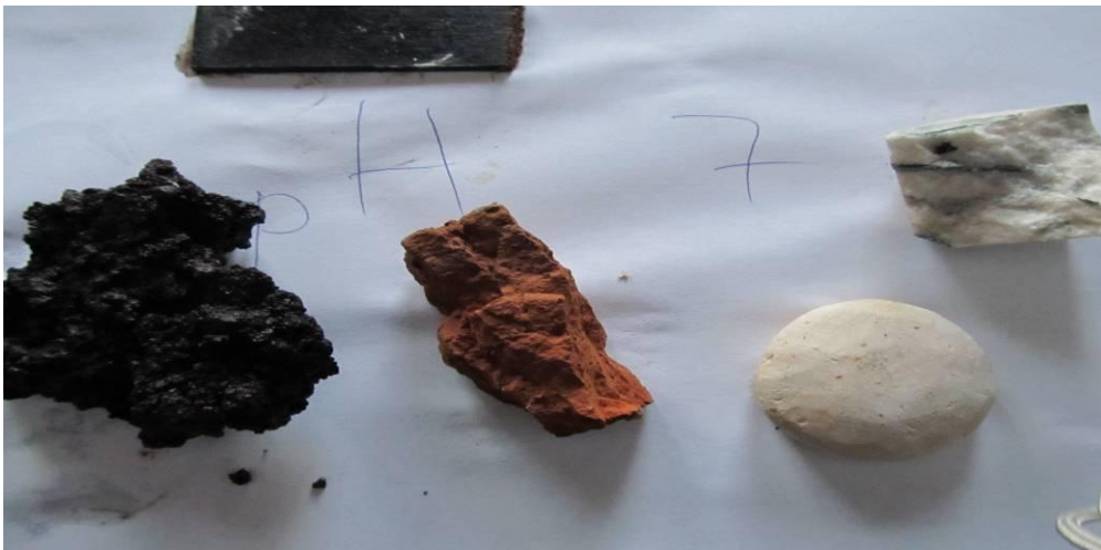
Рис.4.3. Фото зразків, що досліджувалися, після експерименту занурення на 45 діб : б) рН=6-7.
