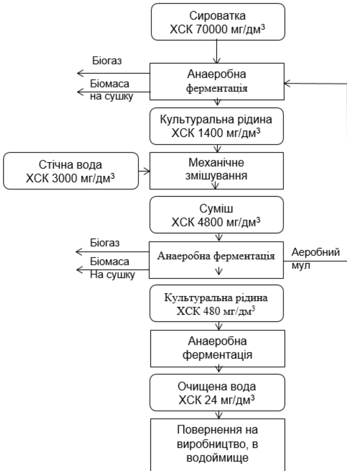
Рис. 2. Процесуально-технологічна схема переробки загального стоку і сироватки з роздільною анаеробною ферментацією
