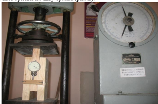
Рис.2. Випробовування зразка на саморізах (початкове положення)
