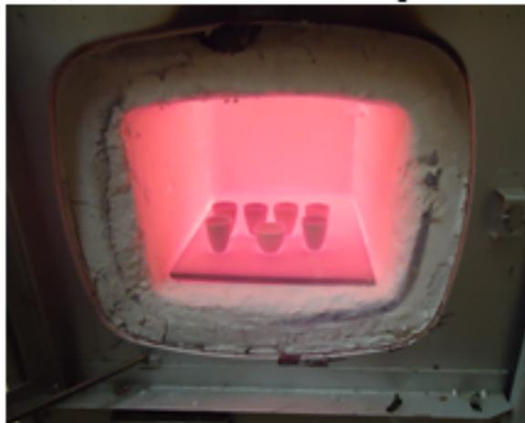
Рис. 4.2. Фото процесу прожарювання проб сапропелю
