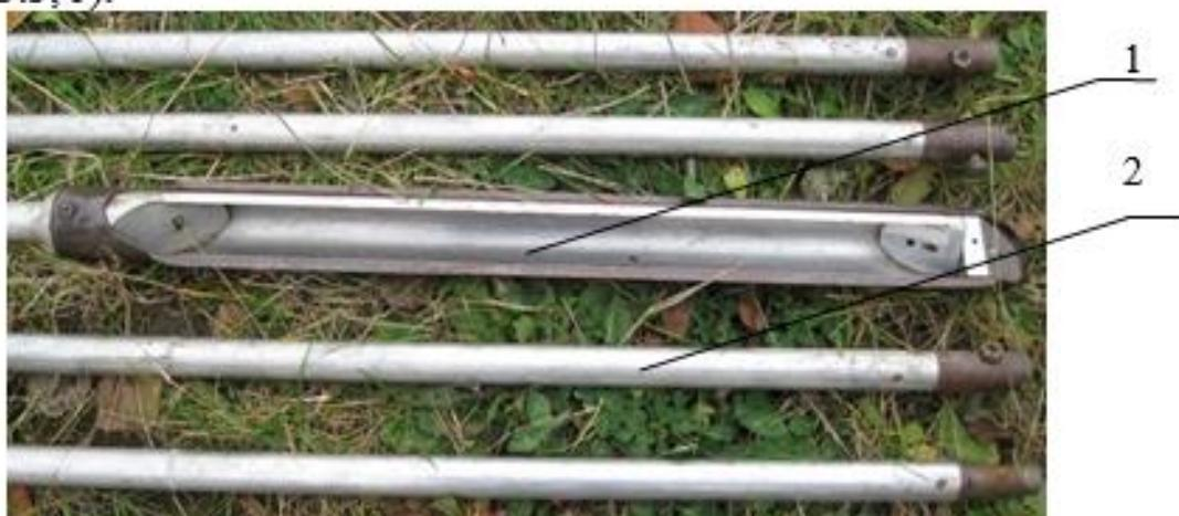
Рис. 3.2. Фото сапропелерозвідувального бура: 1 – пробовідбірний човник; 2 – подовжуvalальні штанги з фіксаторами
