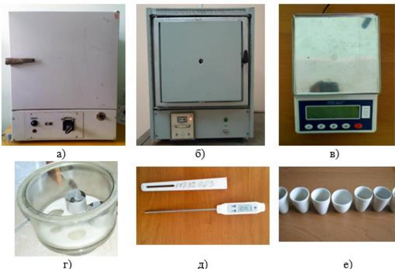
Рис. 3.3. Прилади та обладнання для проведення дослідження: а – сушильна електрошафа СНОЛ – 3,5.3,5.3,5/3 ИЗ; б – муфельна електропіч СНОЛ – 1,6.2,5.1/11 ИЗ; в – електронні ваги ТЛВ-0,5; г – ексикатор із бюксами; д – термометр-щуп електронний TFA 301018; е – фарфорові бюкси
