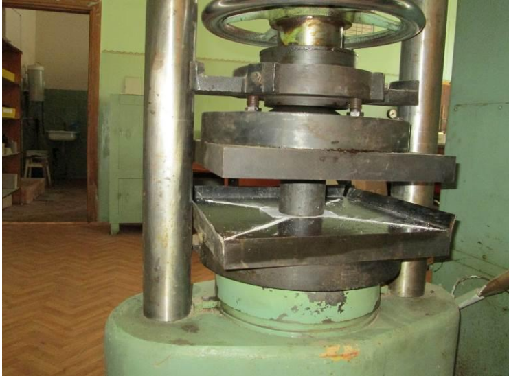
Рис. 1.8 Випробування зразка на гідравлічному пресі
