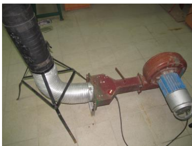
Рисунок 3.8 – Світлина лабораторної установки для дослідження процесу сушіння зерен сої
