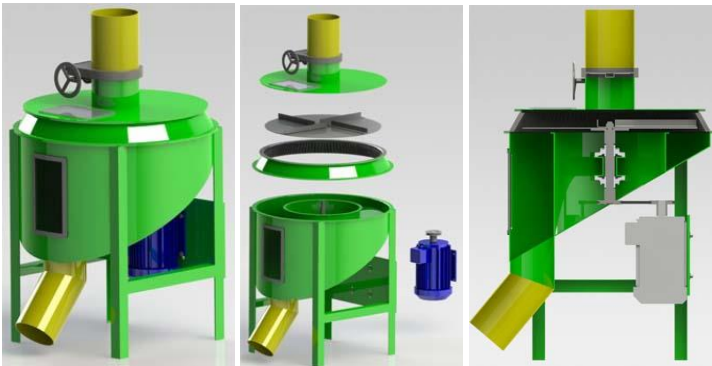
Рисунок 5.2 – 3-D модель пристрою підготовки сої до сушіння
