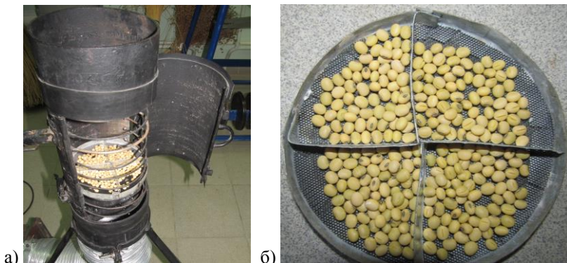
Рисунок 3.9 – Світлина внутрішньої будови установки: а – розміщення касет; б – касета з матеріалом
