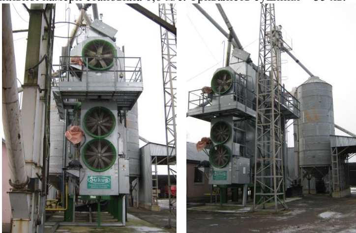
Рисунок 5.3 – Сушарка зерен сої із підготовкою матеріалу до сушіння
