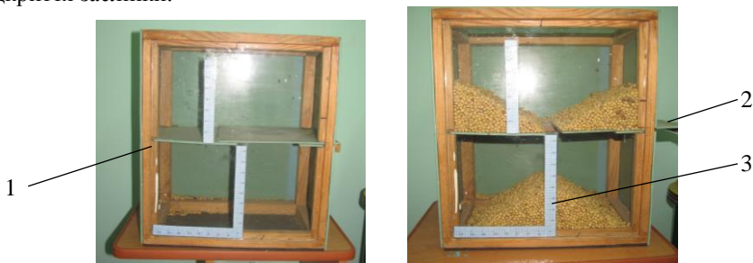
Рисунок 3.3 – Прилад для визначення кута природного відкосу: 1 – прямокутний паралелепіпед, 2 – заслінка, 3 – міліметрова шкала
