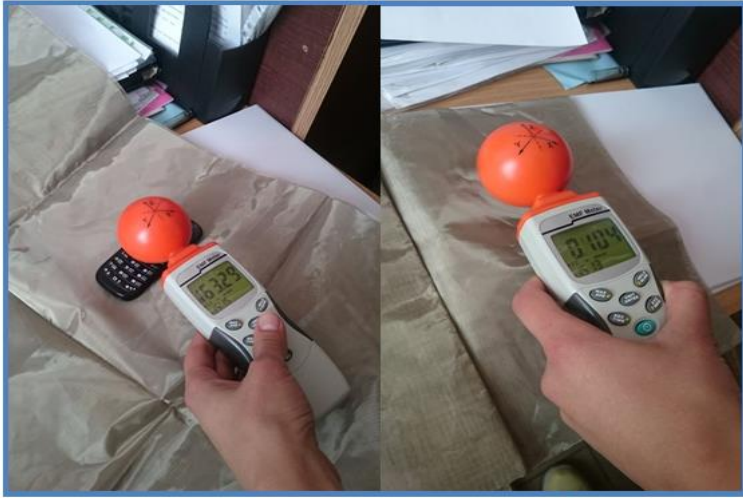
Рис.1. Рівні випромінювання від телефону при вхідному виклику: А- без застосування екранування, Б- при використанні 2х шарів екрануючої тканини
