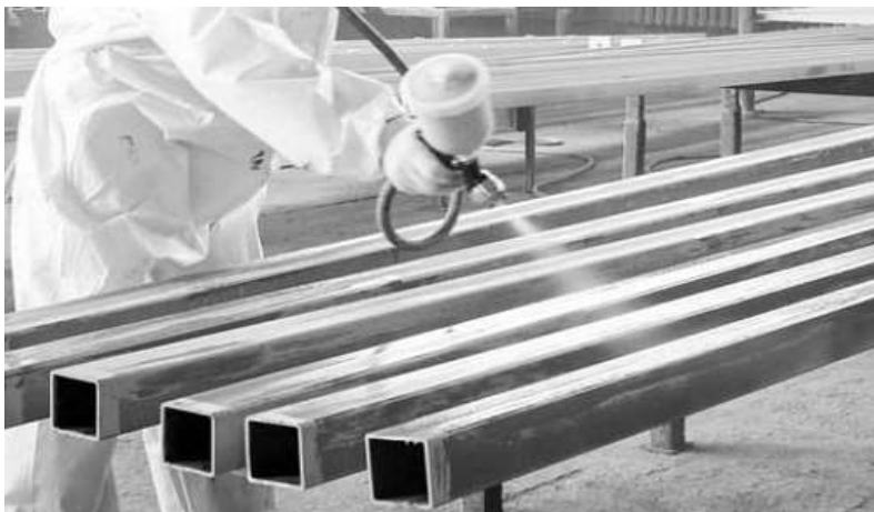
Рис 3. Метод холодного цинкування
