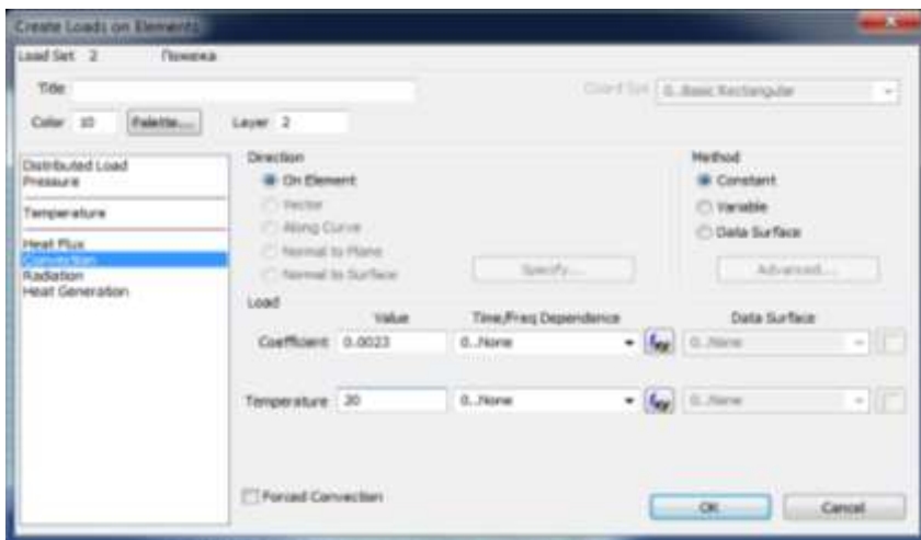
Рис.7. Діалогова панель «Create Loads on Elements» для задання навантаження на весь елемент (тут - тепловіддачі)
