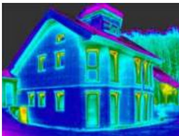
Рис.2 Тепловтрати "пасивного будинку"
