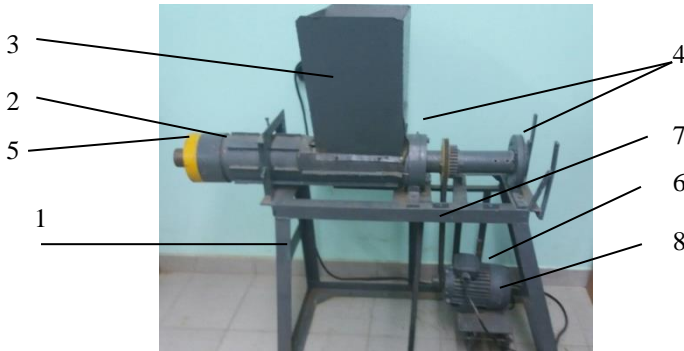
Рис. 2 – Дослідна установка шнекового дозатора
