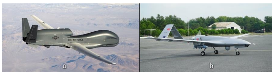
Рисунок – 1. а – стратегічний розвідувальний БПЛА RQ-4 Global Hawk (США); б – ударний БПЛА Bayraktar TB2 (Туреччина)
