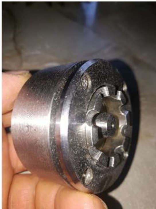
Рисунок 2 – Струминна головка для генерації криги безкамерним способом
