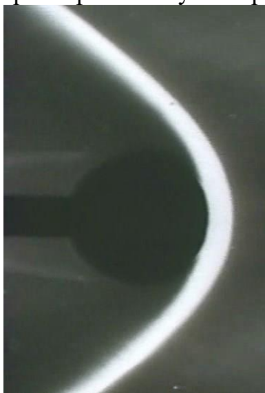
Рисунок 2 – Схема криволінійного стрибка ущільнення перед циліндричним тілом
