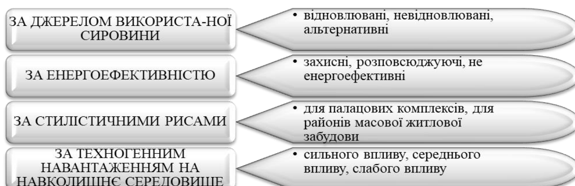
Рисунок 2 – Види інноваційних технології виробництва будівельних матеріалів, складено автором згідно [2–4]
