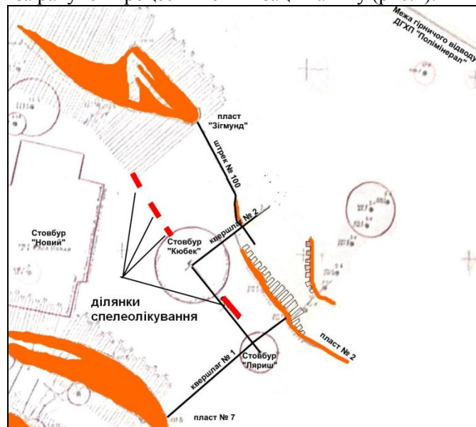
Рис. 2. Розташування пропонуваніх ділянок спелеолікування відносно відроблених калійних пластів Зігмунд, №2 та 7, яке треба враховувати при вентиляванні гірничих виробок для підвищення ефективності спелеопроцедур.
