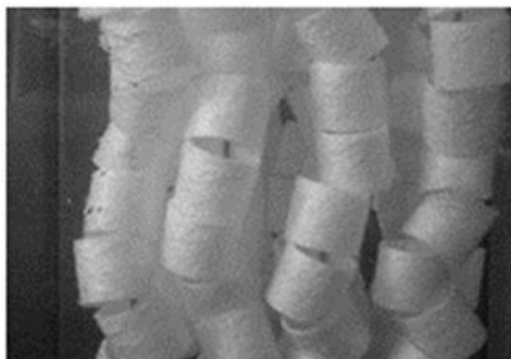
Рисунок 1 – Кассеты с волокнисто-пористым носителем биомассы производства ООО «Гефлис» (РБ)
