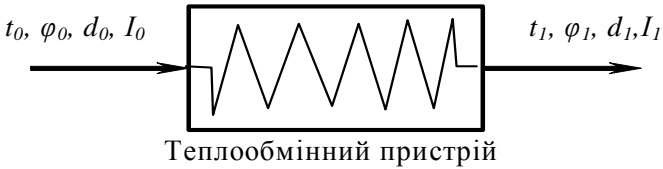
Рис. 2.4. Схема до розрахунку параметрів сушильного агента
