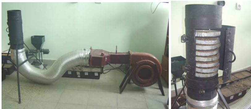
Рис. 2.15. Лабораторна установка для дослідження процесу конвективного сушіння вороху насіння трав
