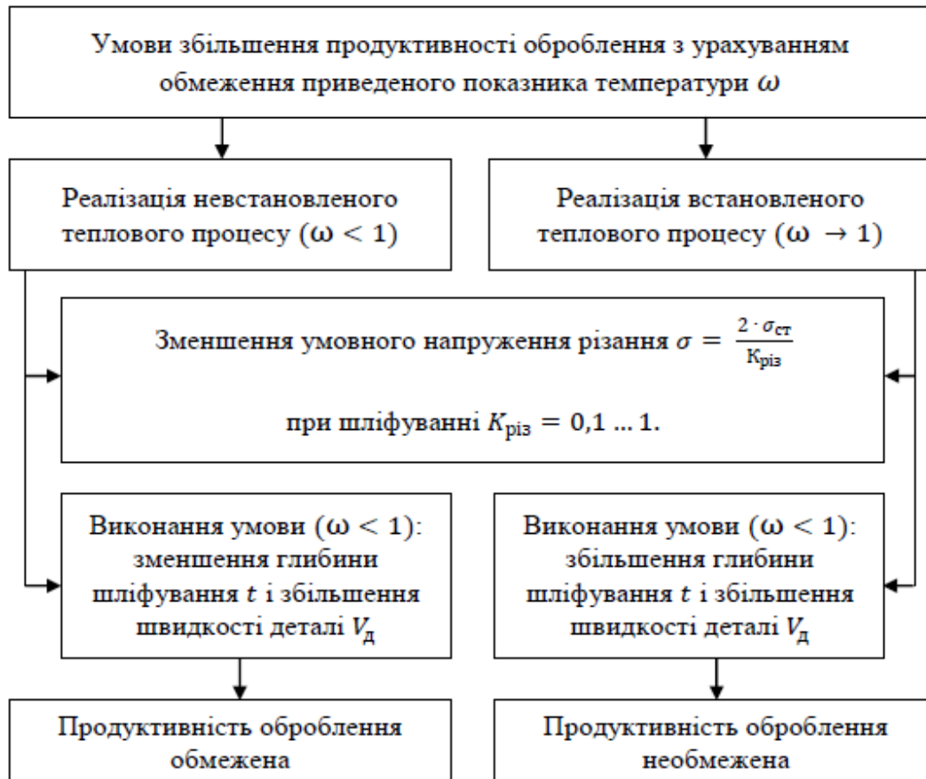
Рис. 11. Структурно-функціональна система адаптивної системи керування температурою безцентрового шліфування базових поверхонь обертання кілець роликотішлипників
