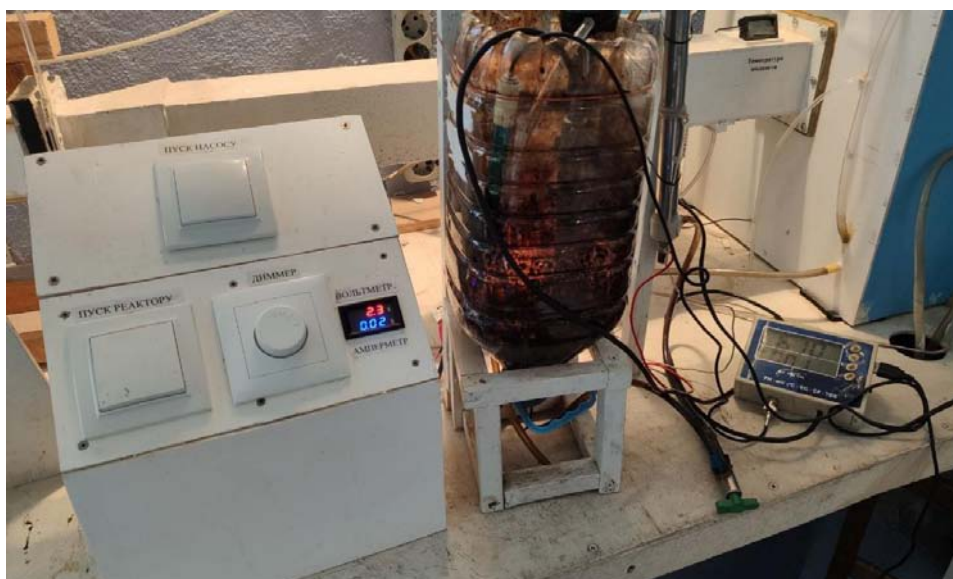
Рис.1. Експериментальний стенд для дослідження очищення лляльних вод від нафтопродуктів
