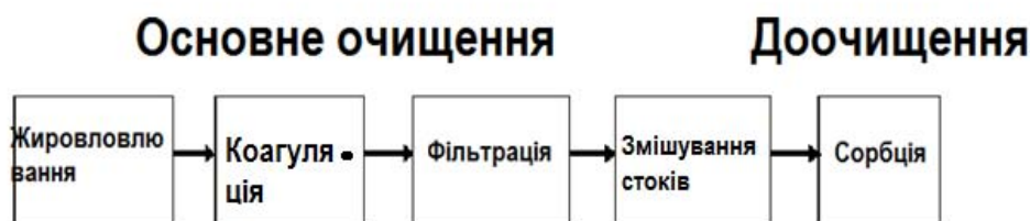
Рисунок 3 – Схема очищення стічних вод технологічних ліній виробництва кисломолочного сиру та вершкового масла
