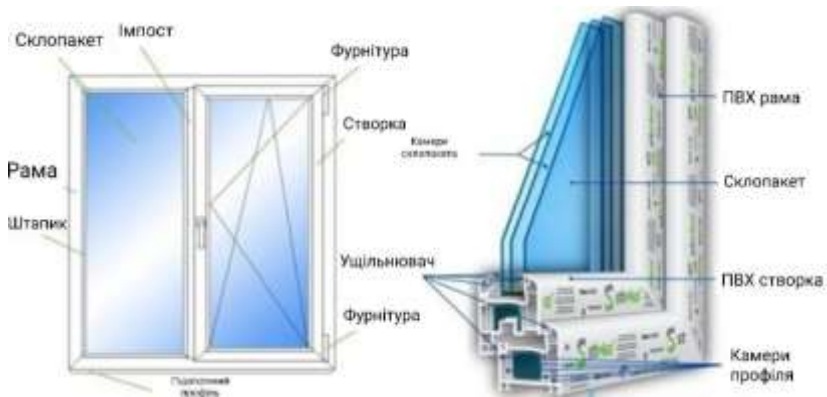
Рисунок 2. Стандартна конструкція віконного блоку.
