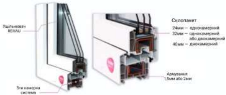
Рисунок 4. Внутрішня будова вікон REHAU GENEО.
