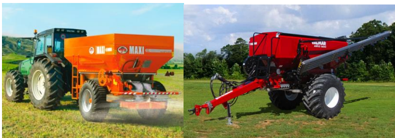
Рисунок – Розкидачі мінеральних добрив: а) дисковий розкидач Agrex Maxi; б) штанговий розкидач SALFORD AIRFLO 8608
