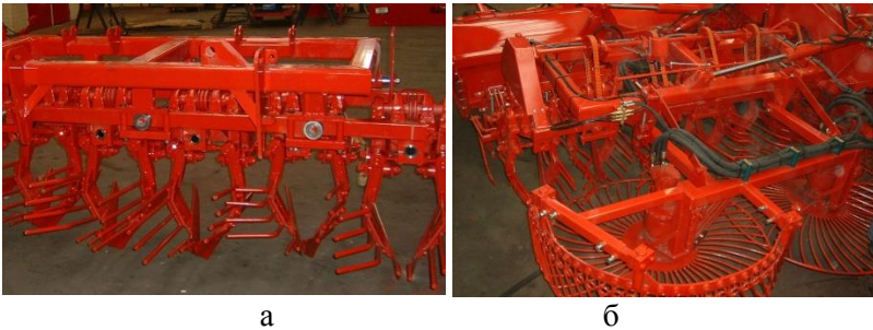
Рисунок 3 – Полицевий підкопуючий пристрій (а) та сепаруючий пристрій роторного типу (б)
