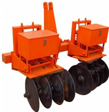
Рисунок – Культиватор лісовий КЛБ-1,7
