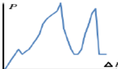
Рис. 6. Діаграма динаміки структури за схемою навантаження на рис. 2 в координатах P \sim \Delta l
