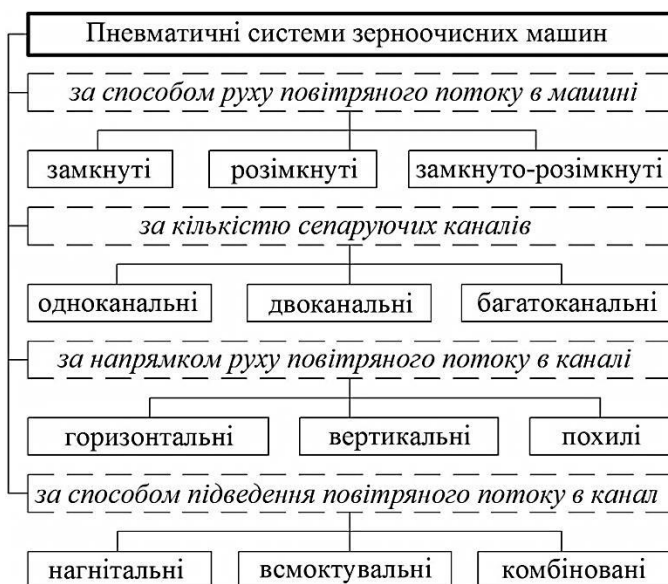
Рис. 1. Класифікація пневматичних систем зерноочисних машин
