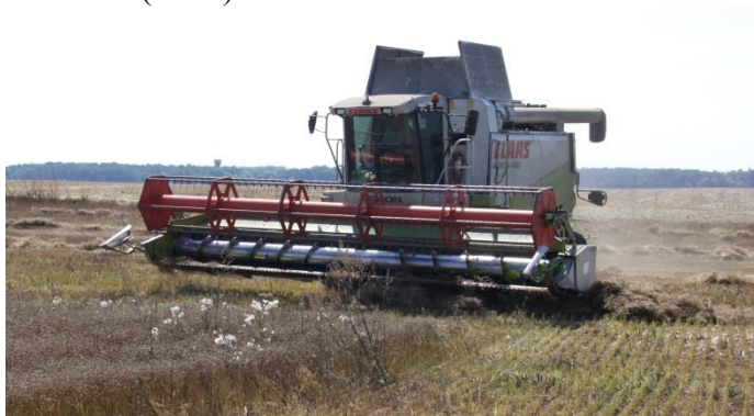
Рисунок 1 – Збирання врожаю льону олійного прямим комбайнуванням
