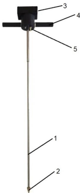
Рисунок 1 – Фото твердоміра ґрунту «Лан-М PRO»: 1 – металевий щуп; 2 – наконечник малий ( d=12,7 мм); 3 – електронний блок; 4 – основа із рукоятки; 5 – наконечник великий ( d=19,1 мм)
