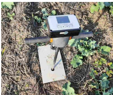
Рисунок 5 – Завершення процесу вимірювання через досягнення максимальної глибини введення твердоміра
