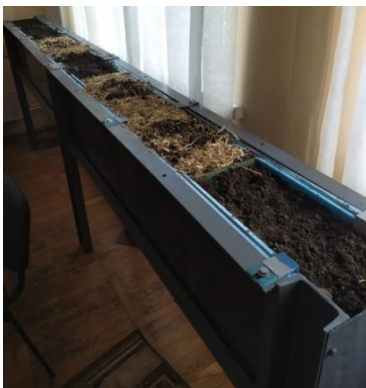
Рисунок 1 – Ґрунтовий канал із закладеними зразками ґрунту
