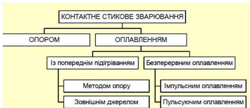
Рисунок 1. Класифікація контактного стикового зварювання
