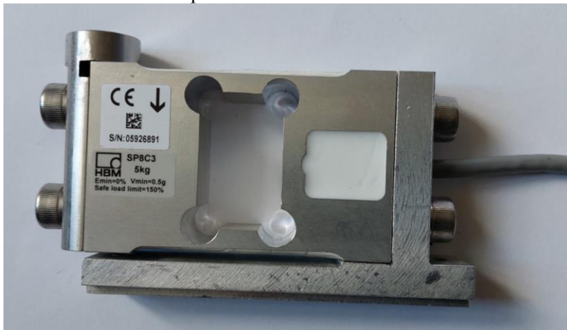
Рисунок 1 – Вид на тензорезисторного датчика ваги SP8C3 з перехідними елементами для кріплення в ваговій комірці технологічної лінії WDH 8002 для дозування інфузійних розчинів
