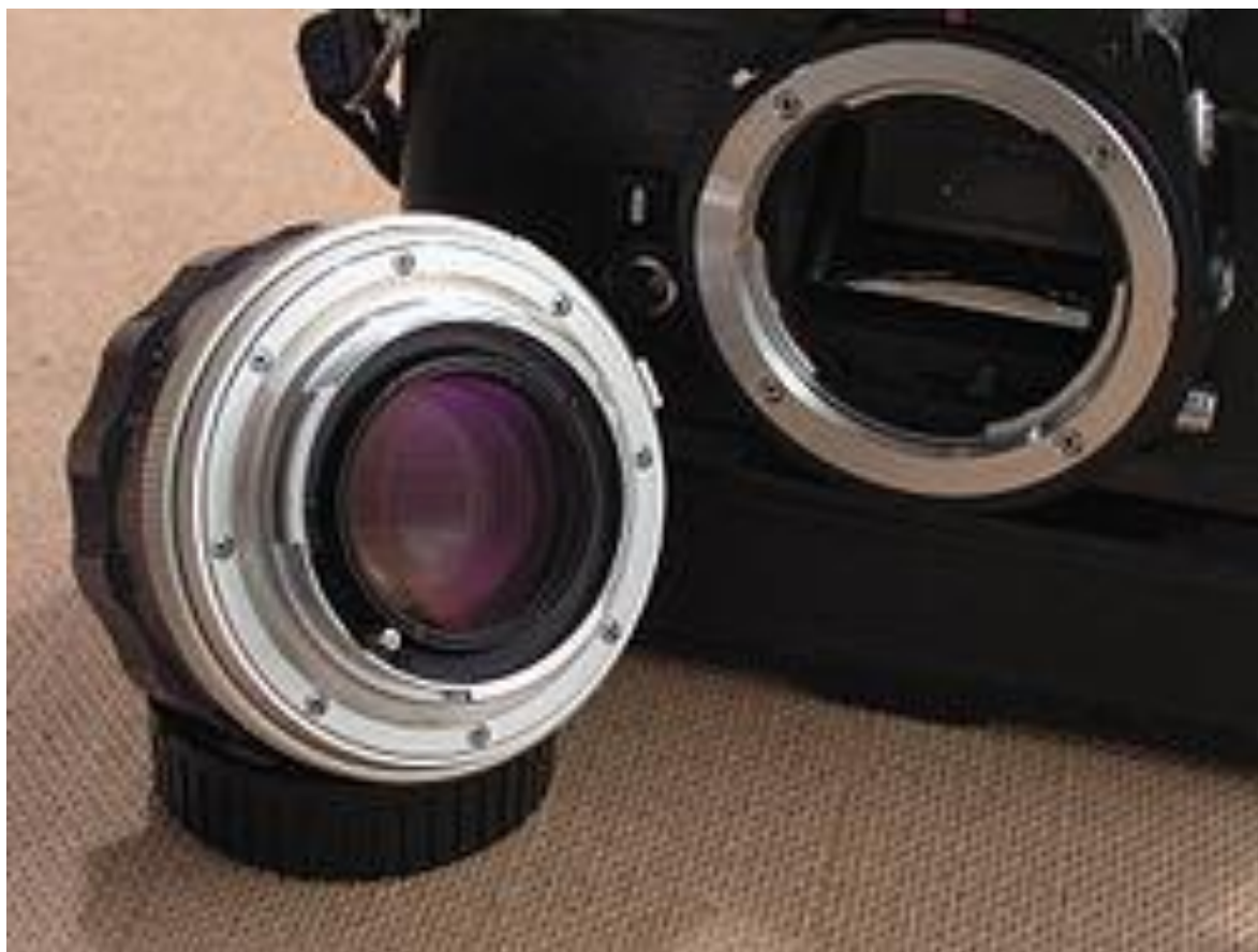
Рисунок 59 – Байонетне кріплення об'єктива фотоапарату
