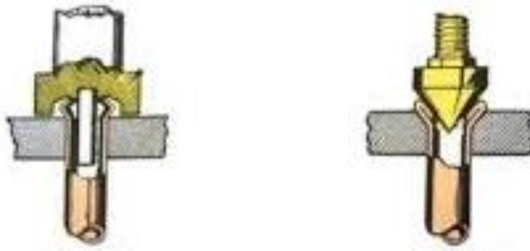
Рисунок 17 – Отримання нероз'ємного з'єднання розвальцюванням
