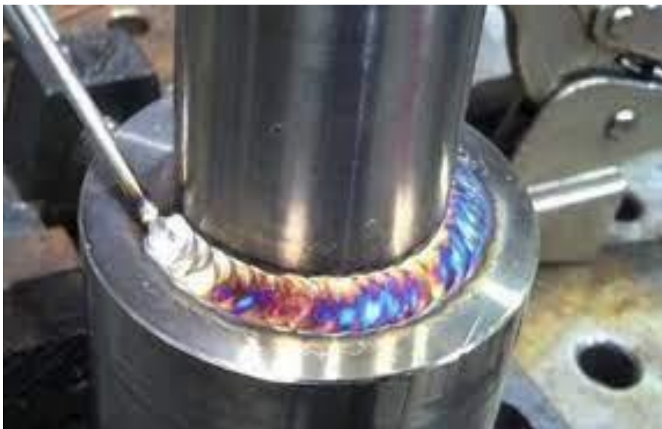
Рисунок 2 – З'єднання отримане при аргонно–дуговому зварюванні
