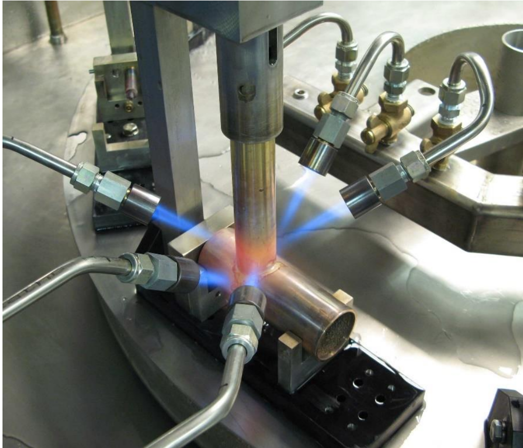
Рисунок 10 – Паяння твердими припоями відкритим полум'ям
