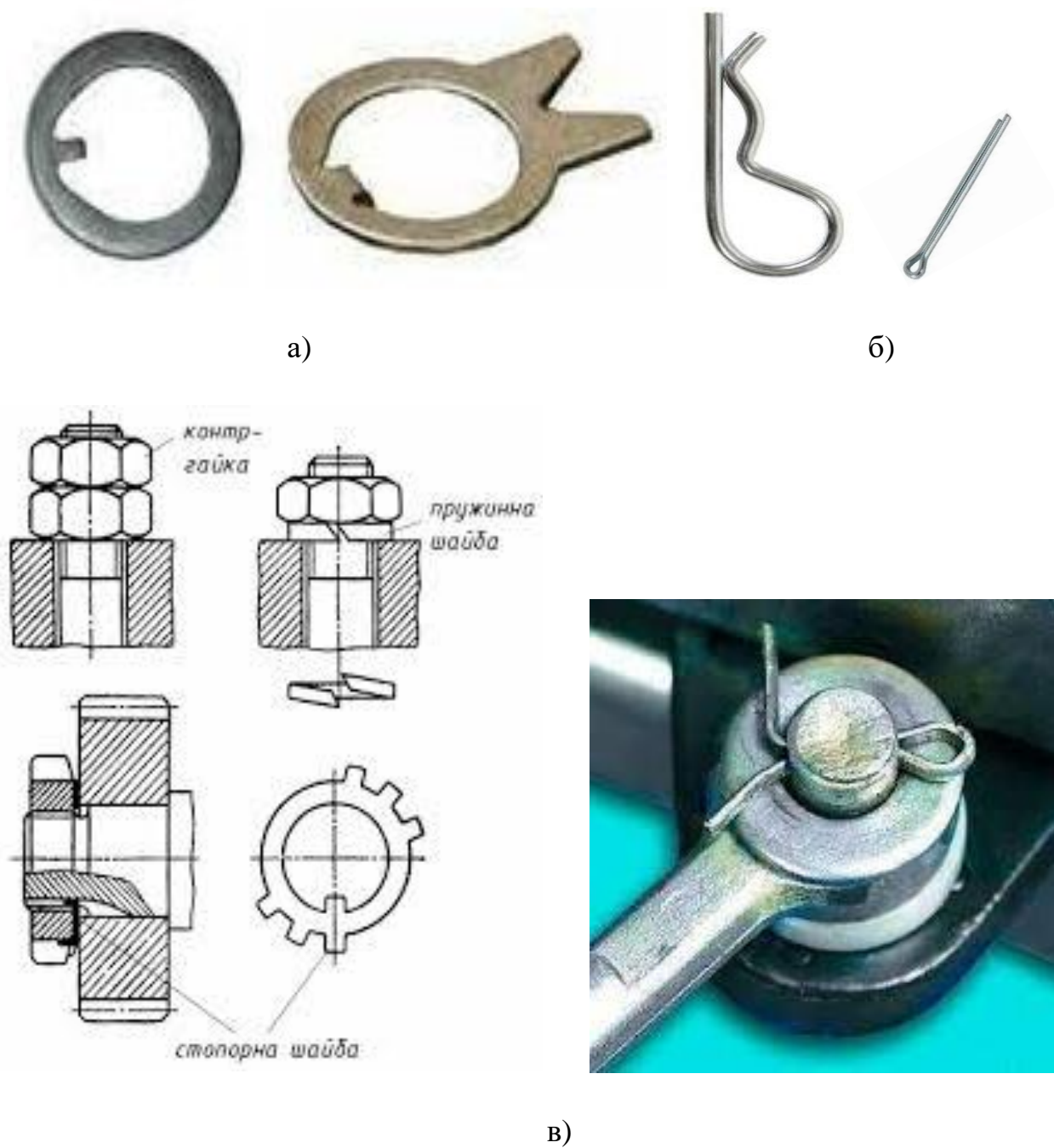
Рисунок 42 – Запобігання самовідгвинчуванню: а – шайби; б – шплінти; в – приклади запобігання самовідгвинчуванню
