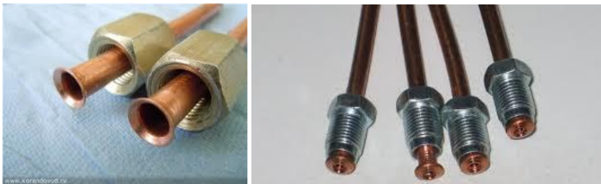
Рисунок 18 – Розвальцьовані деталі для роз'ємного з'єднання
