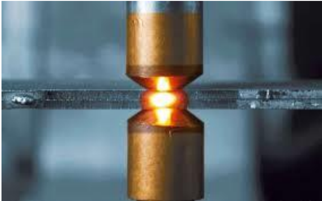
Рисунок 5 – Момент плавлення та з'єднання деталей
