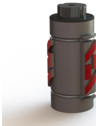
Рис. 1. Кульково-клиновий хон зі змінною геометрією бруска
