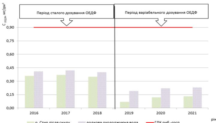
**Рисунок 7 – Вміст ОЕДФ в додатковій та зворотній охолоджуючій воді ОСО ВП РАЕС**
