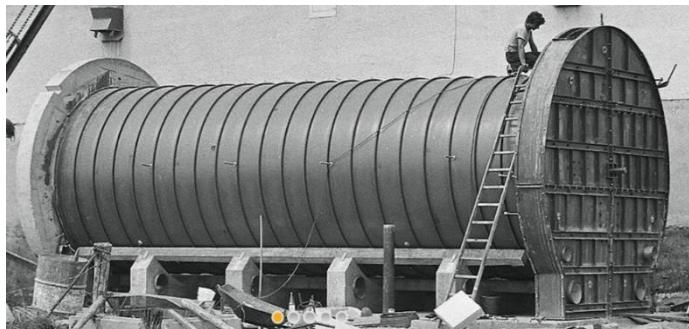
Рисунок 4 – Спірально-фальцевий горизонтальний ферментер
