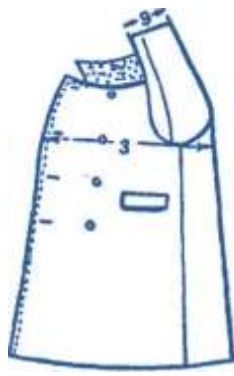
Рис. 6.2 – Вимірювання ширини виробу
