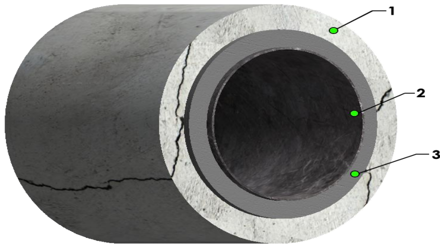
Рис. 1. Метод «гільзування» при ремонті дефектних труб:
