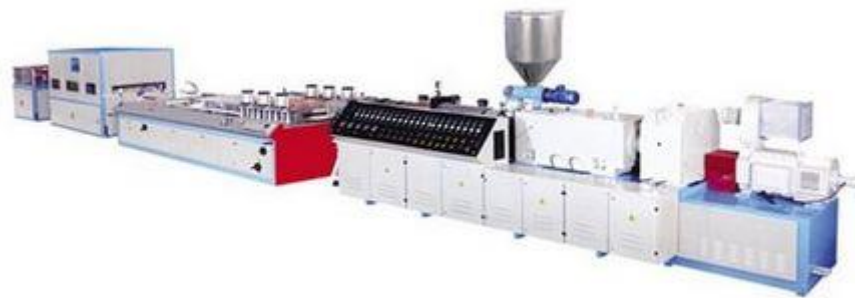
Рис. 3. Лінія для виготовлення композитної терасної дошки [2].
