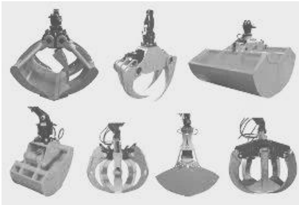
Рисунок 1.9 – Окремі типи грейферів в робототехніці
