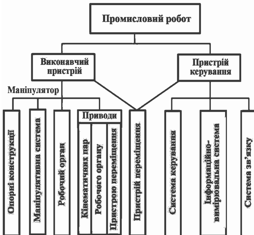
Рисунок 1.3 – Спрощена блок-схема промислового робота
