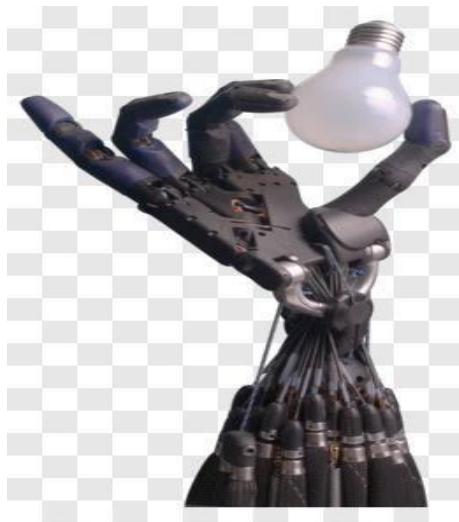
Рисунок 1.6 – Робот «людська» рука з датчиком тиску
