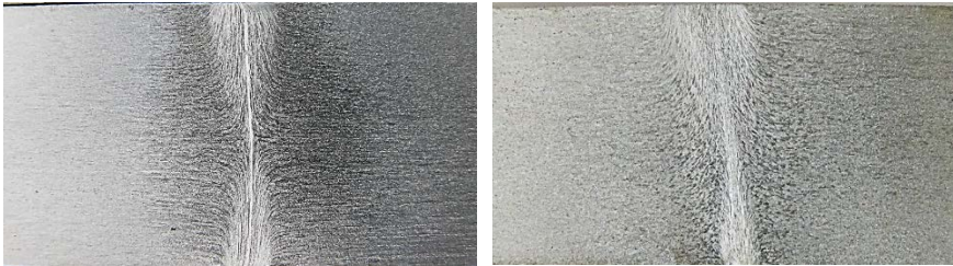
Рис. 2. Структура з'єднання зразків сплаву 2219-T87 товщиною \delta = 15 мм: а - шов впоперек прокату, б - шов уздовж прокату
