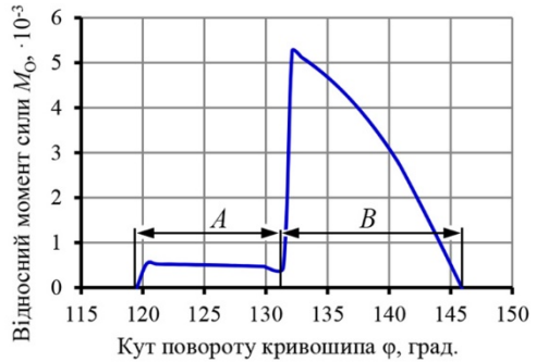
Рис. 2. Схема силового навантаження розклинювального механізму лівого контуру привода натискної плити внаслідок штанцювання картонної заготовки (а), графік залежності відносного моменту сили на приводному валу від кута його повороту (б)
