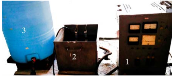
Рис. 1. Установка для синтезу покриттів методом ПЕО (ІМПЕЛІОМ-1): 1 - силовий блок; 2 - електролітна ванна; 3 - холодильне устаткування
