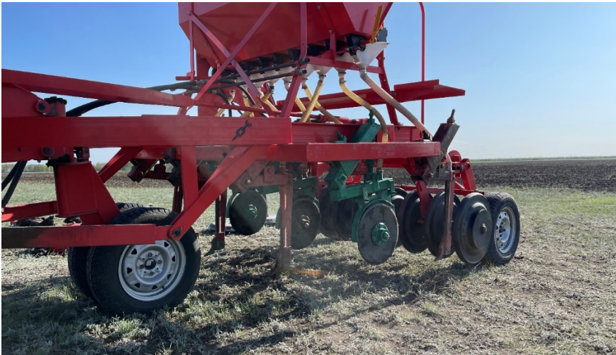
Рис. 1. Експериментальна сівалка із комбінованими сошниками для прямого посіву
