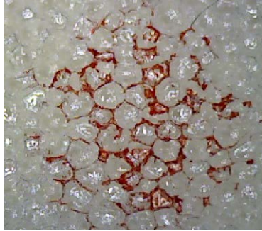
Рис. 2. Зріз структури пінополіуретану, отриманий при 30-ти кратному збільшенні з маскованою частиною досліджуваної області
