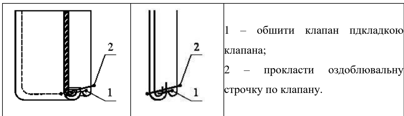
Рис. 12.1. Складальна схема обробки та переріз клапана
