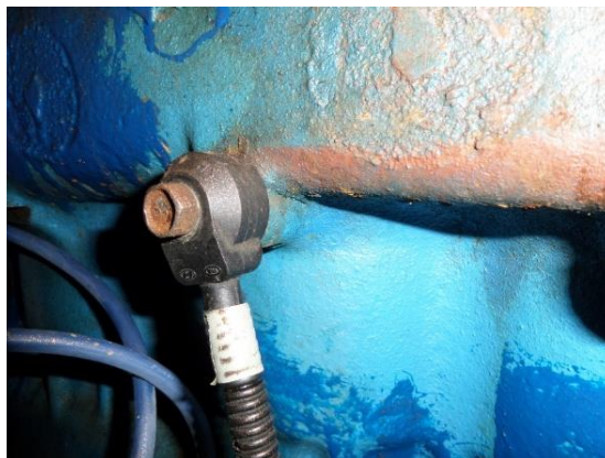
Рисунок 2 – Встановлення датчика детонації на блоку циліндрів газового двигуна
