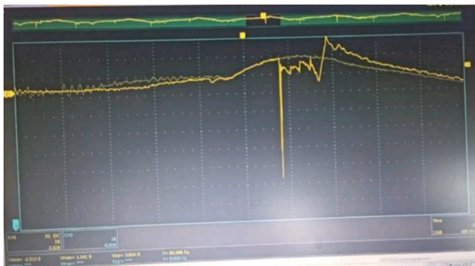
Рисунок 3 – Сигнал датчика детонації в газовому двигуні
