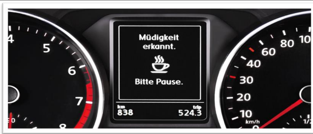
Рисунок 2 - Система розпізнавання втоми на автомобілях Volkswagen
