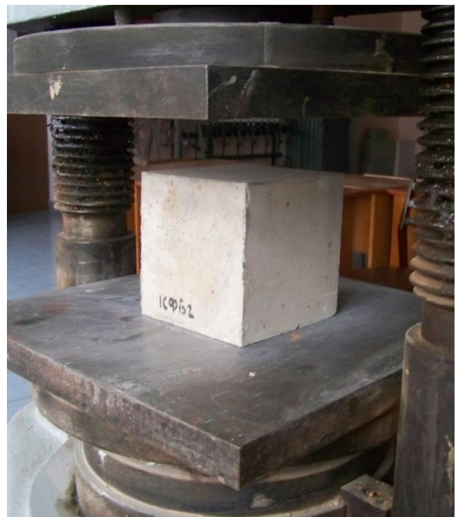
Рисунок 2.5 – Загальний вигляд випробування на стиск призм і кубів
