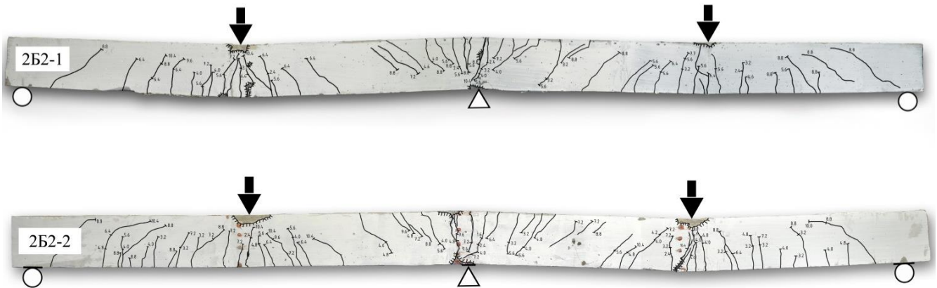
Рисунок 3.14 – Характер руйнування балок 2Б2-1,2
