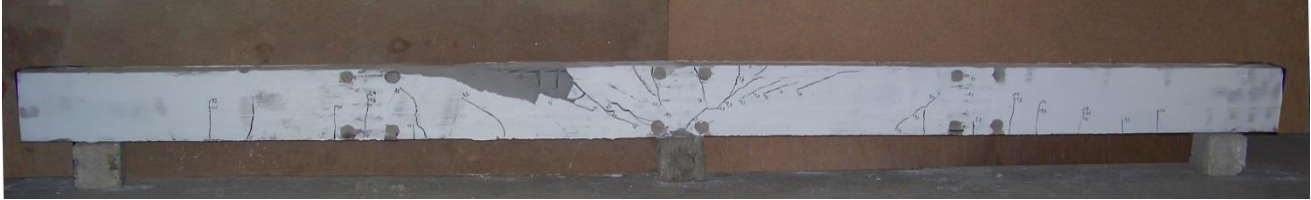
Рисунок 3.1 – Характер руйнування балки 1Б1–1
