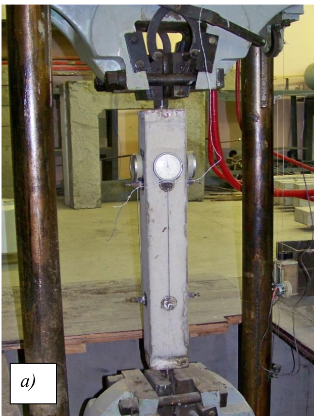
Рисунок 2.6 – Загальний вигляд процесу дослідження призм в розривній машині УММ-50 (а), характер їх руйнування (б)
