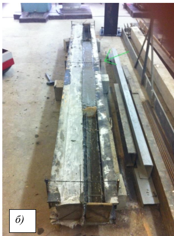
Рисунок 2.12 – Загальний вигляд касетної опалубки (а) та процесу бетонування зразків другої серії (б)
