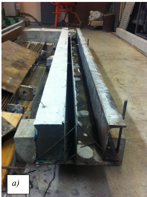
Рисунок 2.12 – Загальний вигляд касетної опалубки (а) та процесу бетонування зразків другої серії (б)
