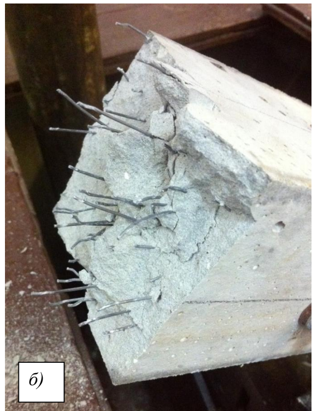
Рисунок 2.6 – Загальний вигляд процесу дослідження призм в розривній машині УММ-50 (а), характер їх руйнування (б)
