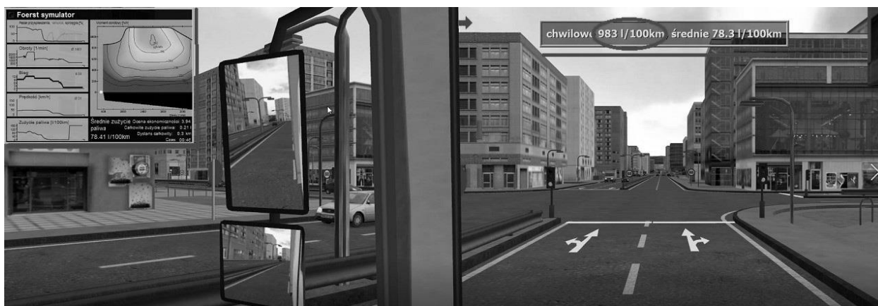
Рисунок 4.15 – Використанням симулятора дорожнього руху під час звичайного проїзду світлофорного об'єкта
