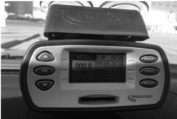
Рисунок 3.6 – Використання VBOX mini на транспортному засобі:
