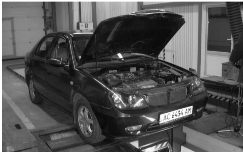
Рисунок 3.1 – Стендові випробування автомобіля Geely СК-1
