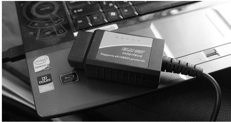
Рисунок 3.10 – Діагностичний пристрій, підключення через OBD II
