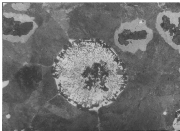
Рис.4.3 – Структура сфероїда \Gamma + \epsilon нормалізованого високомідистого чавуну \text{Cu}=8,53\% мас. \times 400
