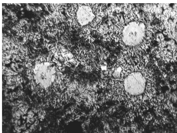
Рис. 4.22 – Типова структура бейніту для сплавів Cu – 6...12 мас.%, t_{iz}=450^{\circ}\text{C} . Травл. \times 100
