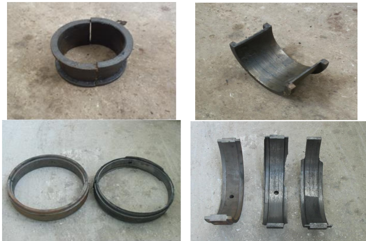
Рис. 7.21 – Зовнішній вигляд вкладок проміжного підшипника шнека транспортної системи різних агрегатів з мідистого чавуну (складу С– 2,8 % мас., Si - 2,6 % мас., Mn – 0.11%, Cu - 8.53 % мас. при вмісті Р, S, Mg \leq 0.1 % мас., решта Fe)
