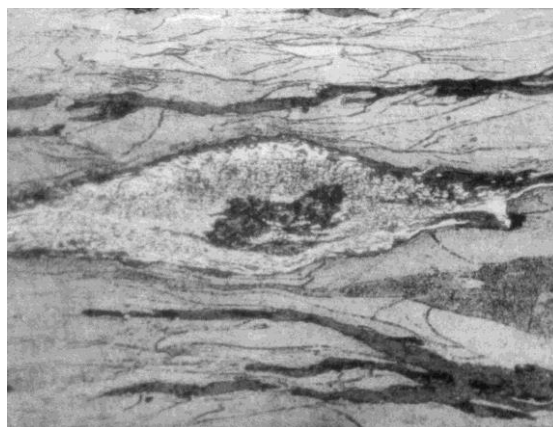
Рис. 7.10 – Типовий вигляд сфероїдів \Gamma+\epsilon холоднодеформованих ЛКМ \times 400 : а – ступінь деформації 30 %; б – ступінь деформації 60 %.
