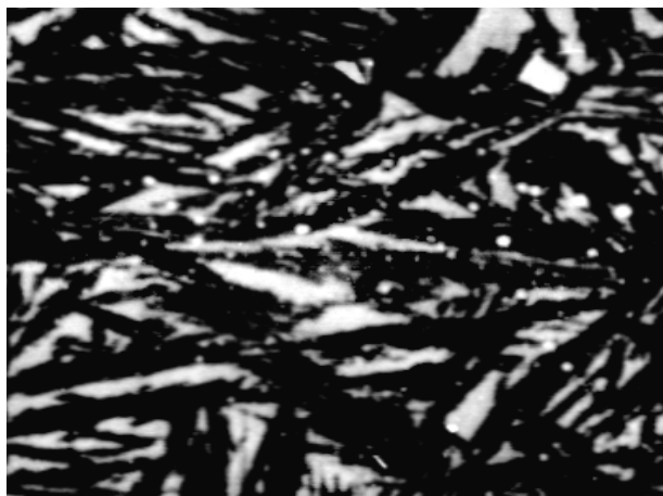
Рис. 4.23 – Мікроструктура нижнього бейніту з характерними точковими вкрапленнями \varepsilon -фази для сплавів \text{Cu} > 6 мас.%, t_{\text{із.}} = 350 °C. \times 1000
