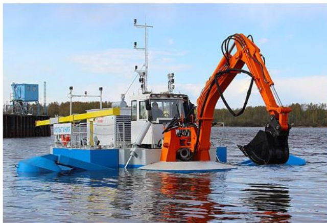
Рисунок 3.4 – Фото багатофункціонального земснаряду «Амфібія-600»
