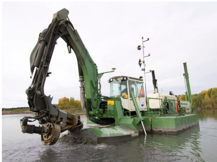
Рисунок 3.3 – Загальний вигляд багатофункціонального самохідного землевсмоктуючого снаряду модифікації "Watermaster Classic IV"
