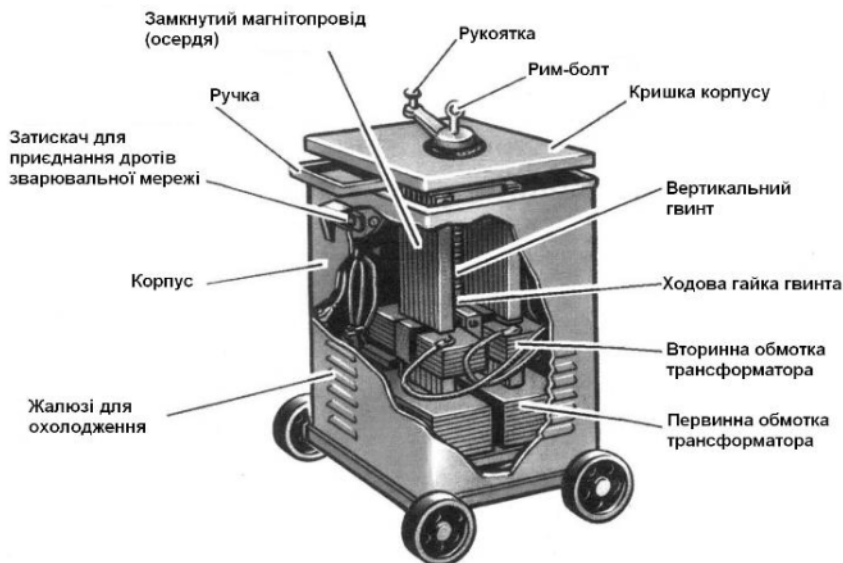
Рисунок 5.7 – Зварювальний трансформатор
