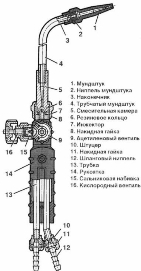
Рисунок 6.5 – Будова інжекторного пальника
