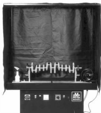
Рисунок 10.14 - Магнітний дефектоскоп, для виявлення тріщин у колінчастих валах
