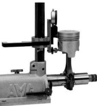
Рисунок 10.9 – Перевірка шатуна на згин у зборі із поршнем
