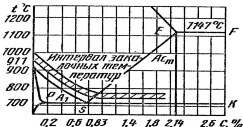
Рисунок 4.3 – Оптимальний інтервал температур гартування вуглецевих сталей
