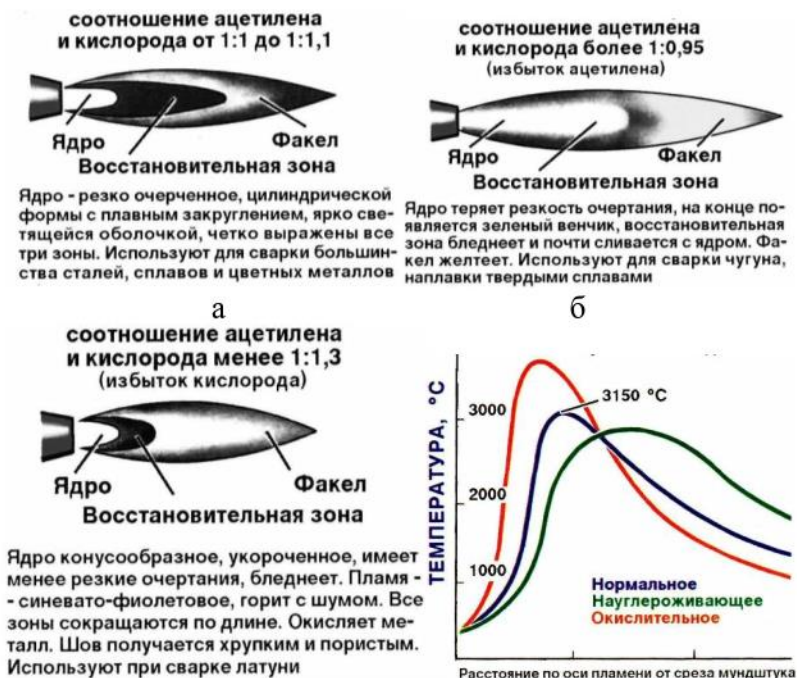
Рисунок 6.2. Види ацетилено-кисневого полум'я: а – основне; б – науглецевлююче; в – окислювальне; г – температурні криві
