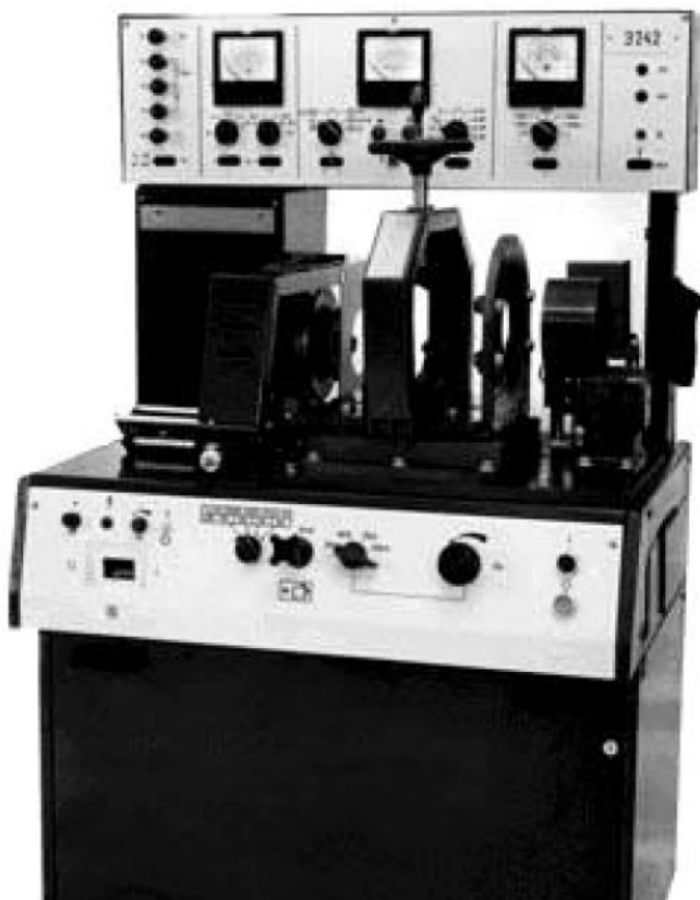
Рисунок 14.4 – Фото стенда Э-242 для перевірки приладів електрообладнання
