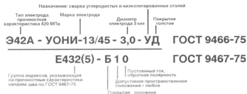
Рисунок 5.9 - Приклад маркування електрода
