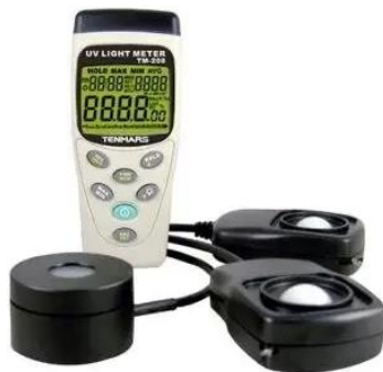
Рис. 2.21. Люксметр та насадки до нього для вимірювання яскравості
