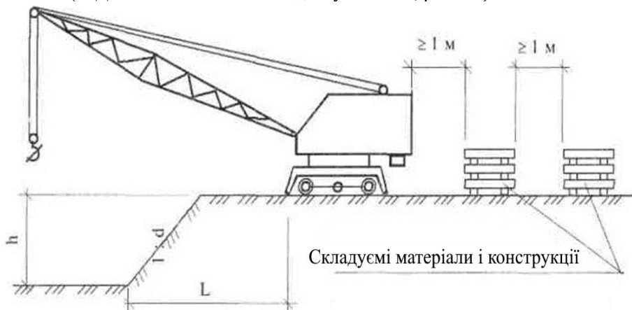
Рисунок 3.7. Схема визначення відстані до опори машини
