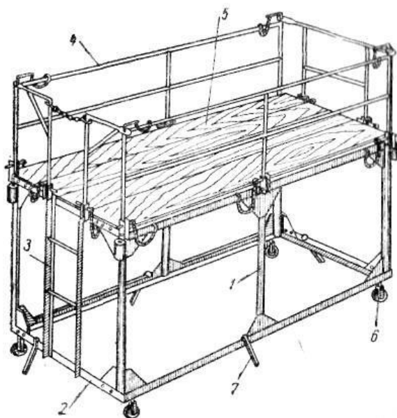
Рисунок 3.30. Блокові риштування висотою 1,7 м: 1 – стійка поздовжньої рами; 2 – сполучні кутники; 3 – сходи; 4 – огорожа; 5 – робочий настил; 6 – ролики; 7 – штирі
