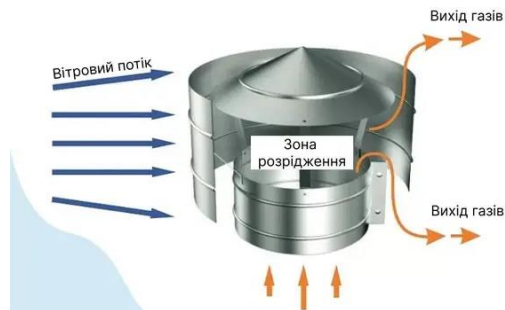
Рисунок 2.18. Дефлектор типу ЦАГІ
