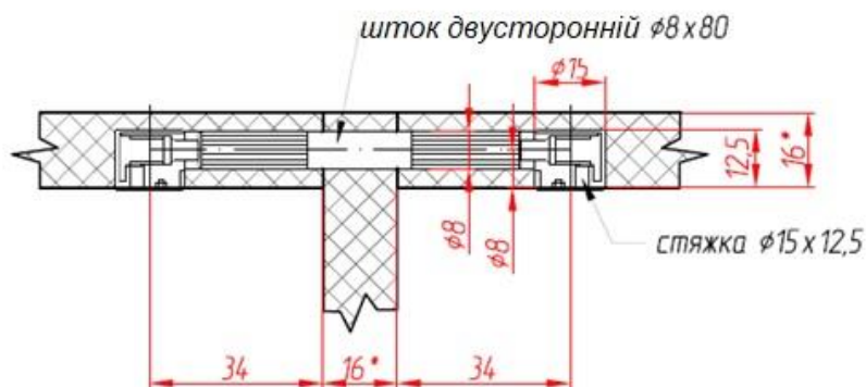
Рисунок 9.20 - Схема двостороннього ексцентрикового стягування
