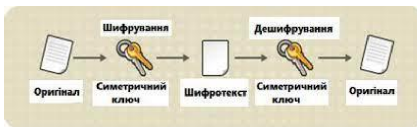
Рисунок 3.3 – Алгоритм шифрування передачі даних за допомогою ключів шифрування
