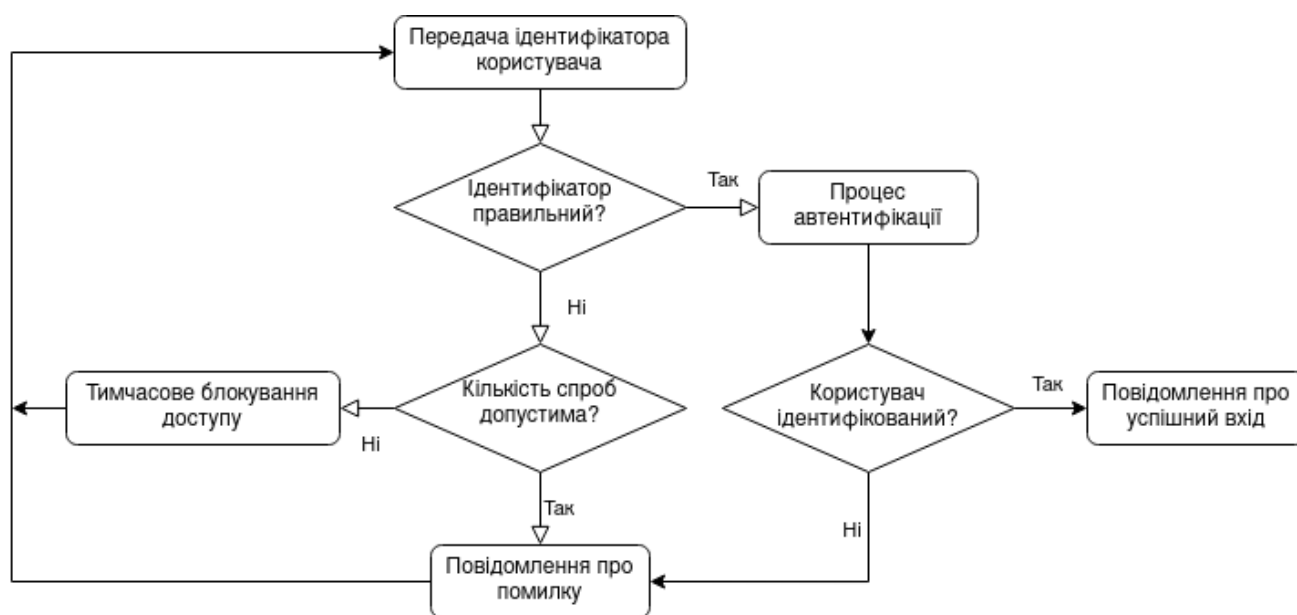
Рисунок 3.2 – Схема роботи механізму автентифікації
