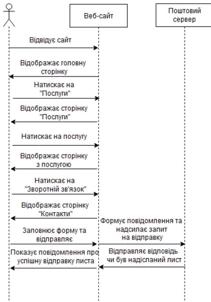
Рисунок 2.1 – Діаграма послідовностей взаємодії користувача з сайтом
