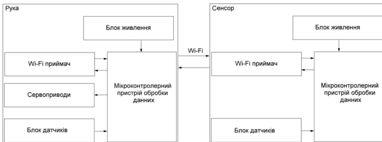
Рисунок 2.1 – Структурна схема програмно-апаратного комплексу
