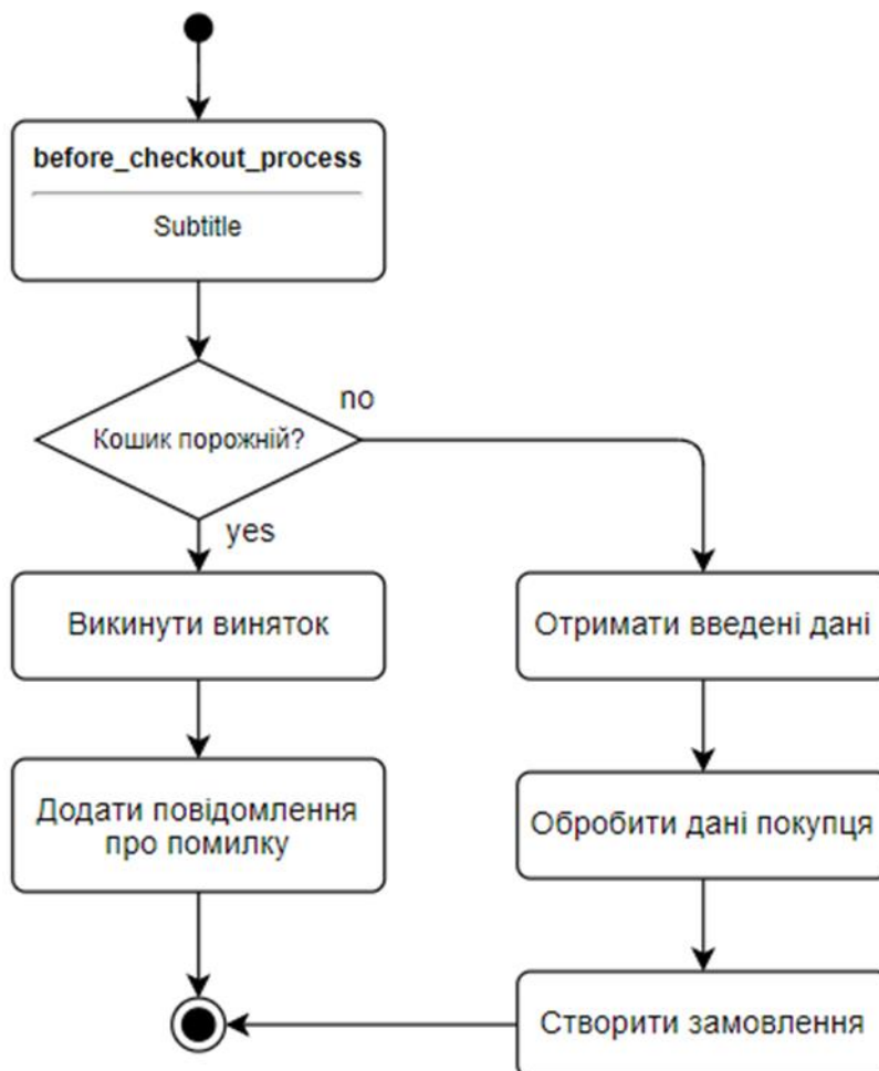
Рисунок 3.3 – UML-діаграма діяльності функції process_checkout
